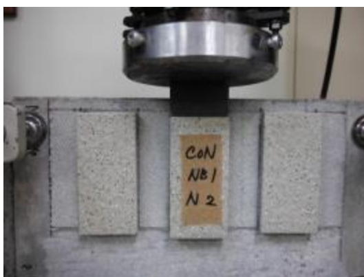
タイル小口への押し込み荷重実施状況
