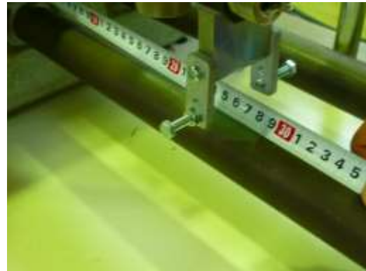
写真 9.4 加力点状況(長さ 265mm)
