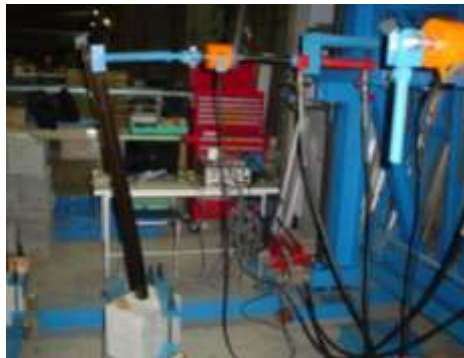
写真 13.1 支柱への載荷状況
