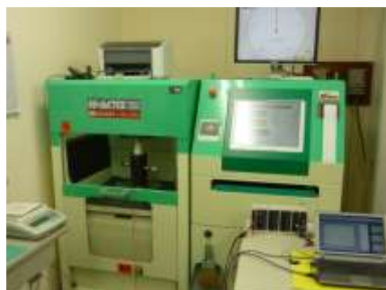
写真 4.1 圧縮強度試験及び静弾性率測定状況
