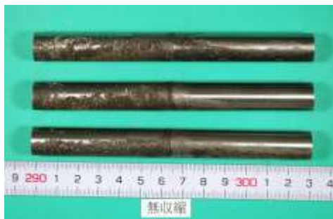
「無収縮モルタル」 写真 11.11 棒鋼側面 1(型枠底面側)
