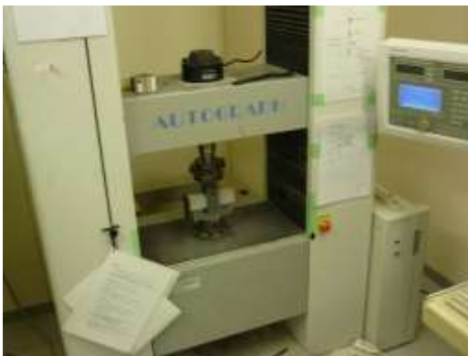
写真 6.1 曲げ強度試験全景
