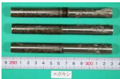
「エポキシ樹脂系グラウト」 写真 11.13 棒鋼側面 1(型枠底面側)
