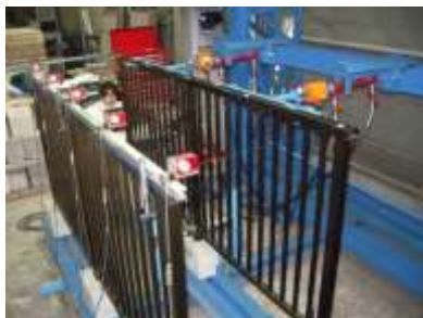
写真 12.1 手摺ユニットへの載荷状況
