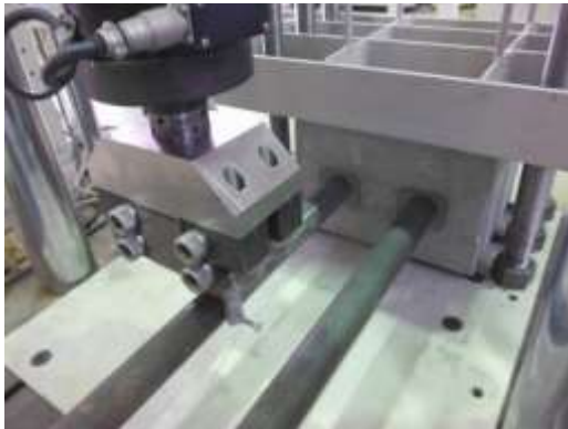
写真 9.3 試験体固定状況
