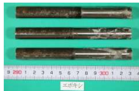
「エポキシ樹脂系グラウト」 写真 11.14 棒鋼側面 2(打設面側)
