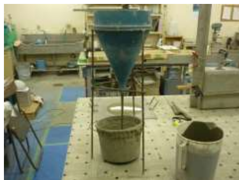
写真 2.2 P 漏斗測定器状況
