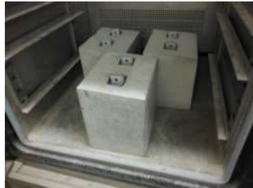
写真 8.4 温冷繰返し状況(恒温恒湿槽内)
