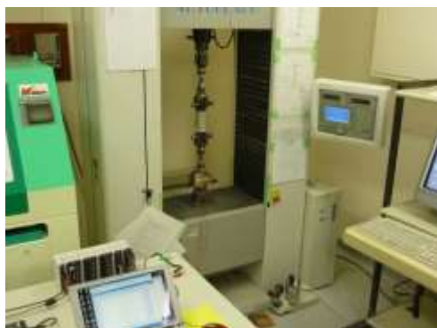
写真 5.1 直接引張強度試験及び静弾性率測定状況
