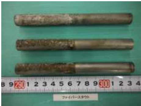
「ファイバースタウト」 写真 11.9 棒鋼側面 1(型枠底面側)
