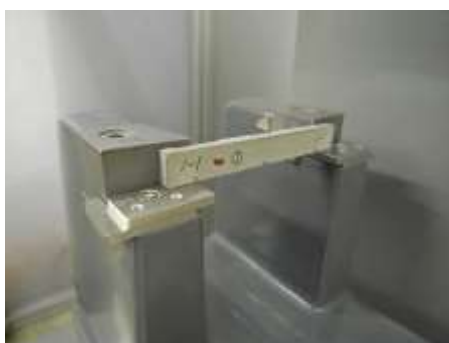
写真 10.3 設置状況(縦方向打撃)
