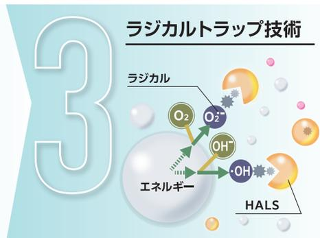
発生を抑えきれなかったラジカルを光安定剤(HALS)が制御します。塗膜劣化を大幅に抑えます。
