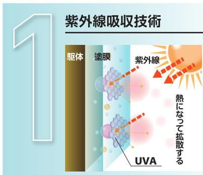
紫外線が当たるとそのエネルギーを紫外線吸収剤(UVA)が吸収し熱に変換します。
