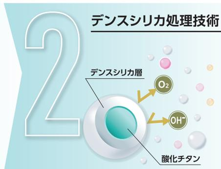
従来とは異なる独自の酸化チタン表面処理技術によりラジカルの発生を抑え耐候性を向上させます。
