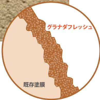
細かい骨材が素早く凹み部分に入り込みます。独特な風合いを損ねることなく新築のような美しい仕上りに。
