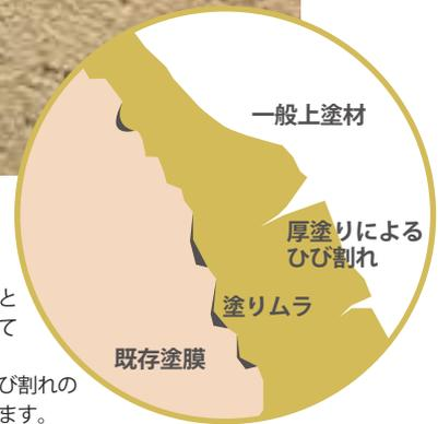
意匠性の高い砂壁状、土壁状の独特な凹凸面に入りにくく、全ての凹凸に塗り込むとパターンや質感を損ねてしまうだけでなく、厚塗りになることでひび割れの原因となる場合もあります。
